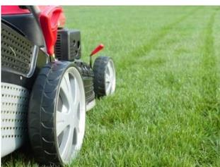
Der Sichelmäher schlägt den Rasen ab, da die Messer sehr schnell drehen. Dies macht die Grashalme etwas geräffter. Achten Sie während des Mähens drauf, dass keine Steine, Äste oder Abfall auf dem Rasen sind, diese können mit einer großen Geschwindigkeit durch die Luft geschleudert werden. Das Messer des Sichelmähers sollte genauso wie die des Spindelmähers jährlich geschliffen werden.
