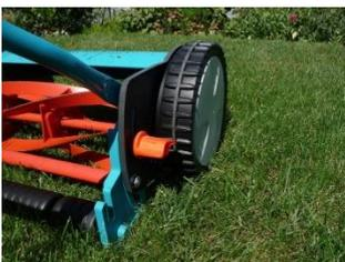
Dieser eignet sich gut um den Rasen kurz zu mähen. Er schneidet den Rasen ab, wodurch Sie feine Grashalme bekommen. Der Spindelmäher verschleißt aber schneller als der Sichelmäher und muss deshalb öfter gewartet werden.
